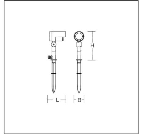
Gartenstrahler mit Erdspieß und Blendschute.. Gehäuse Aluminium-Druckguss pulverbeschichtet. Abdeckung Glas, klar. Mit Erdspieß und 5 m Anschlussleitung inklusive Schuko-Stecker. Strahler einstellbar. Mit Netzspannungs-LED-Modul.
