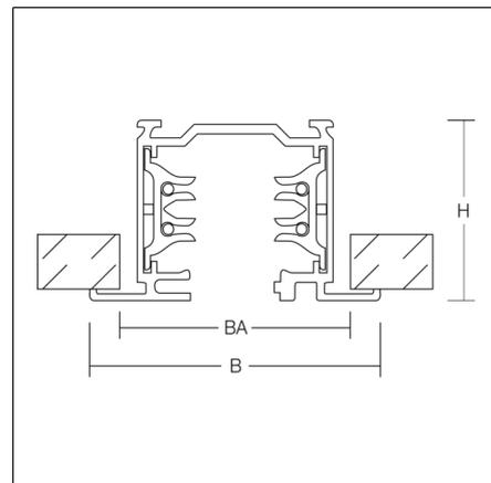
Extrudé aluminium profilé laqué, rails pouvant être raccourcis à volonté, manipulation sans risques, avec quatre alésages de fixation à 100, 990, 1990, 2880 mm.
