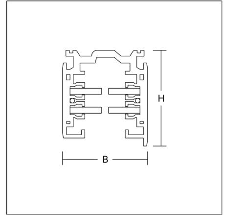
Perfil de aluminio extruido barnizado. Carriles cortables según se desee. Permitido para el alcance de la mano. Línea adicional DALI de 2 polos integrada. Línea de alimentación de 16A / 400V. Línea de control DALI 2x1A / 50V FELV AC.
