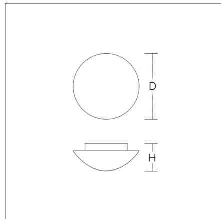
Decorativa luminaria redonda de montaje en superficie. Base de material sintético. El vidrio Triplex proporciona una luz homogénea, suave y antideslumbrante. Apto para Montaje en superficie de techos, Montaje en superficie de la pared. Luminaria esclava. Servicio sólo en combinación con una luminaria maestra correspondiente.
