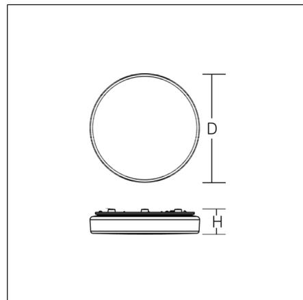
Luminaire apparent LED rond, plat et décoratif. Armature en métal traité époxy. Diffuseur en plastique anti-jaunissement (PMMA) opalin. Fixation du diffuseur par technique de fermeture brevetée (fermeture à pression). Convient à Montage des plafonniers, Flèche murale.
