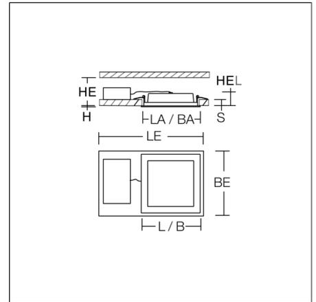
Downlight flexible empotrable, cuadrado, con Multi-funciones. Luminaria para iluminación de emergencia. Carcasa de chapa de acero revestido al polvo. Marco de aluminio revestido al polvo. Difusor de material sintético (PMMA) que no amarillea, microprismático. Tecnología LED backlight proporciona luz homogénea en todo el difusor. Fijación en el techo mediante sistema de muelles. Incluido convertidor externo con conector. Línea de conexión 250 mm.
