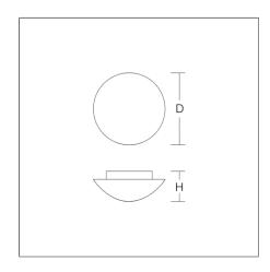
Dekorative runde Anbauleuchte. Armatur Kunststoff. Mundgeblasenes Drei-Schicht-Opalglas (Triplex-Glas) seidenmatt. Glasbefestigung mit Federsystem. Das Triplex-Glas sorgt für besonders homogenes, weiches und blendfreies Licht. Geeignet für Deckenanbau, Wandanbau.
