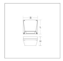
Luminaria de pared para iluminación de emergencia. Carcasa de aluminio inyectado revestido al polvo. Con lente para iluminación de vías de evacuación. Equipo incluido. Sistema de emergencia autónoma con autotest y respuesta a través del bus DALI, exclusivamente al sistema RZB de control DALI.
