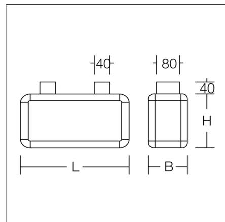
Luminaire apparent rectangulaire au design classique. Pour marquage de voies de secours. Corps en aluminium avec jonctions angulaires en matière synthétique. Plaques en matière synthétique opalines avec pictogramme de secours simple/double face. Appareillage intégré. Convient pour le raccordement à l'alimentation centrale en électricité de secours. Merci d'indiquer le numéro de motif du pictogramme de secours lors de la commande
