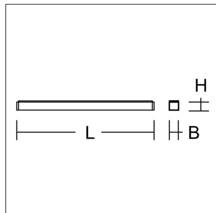
Luminaria de techo de diseño minimalista. Carcasa de perfil de aluminio extruido, revestido al polvo. Tapas finales de aluminio revestido al polvo. Difusor de material sintético (PMMA) que no amarillea, microprismático. Apto para Montaje en superficie de techos, Montaje en superficie de la pared. Equipo externo con línea de conexión.
