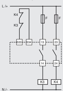
Círculo de retorno para contactores externos con arranque manual o controlado
