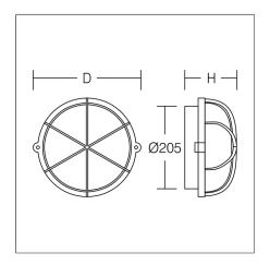
Plafonnier et applique robuste pour l'extérieur. Luminaire et grille de protection en aluminium injecté traité époxy. Avec valve à membrane pour réduire la condensation. Diffuseur en matière synthétique (polycarbonate) opalin. Étrier de fixation en inox avec compensation de la tolérance des trous de perçage. Raccordement secteur 2 x 3 x 1,5 mm². Module LED échangeable.
