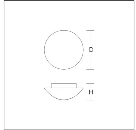
Dekorative runde Anbauleuchte. Armatur Kunststoff. Mundgeblasenes Drei-Schicht-Opalglas (Triplex-Glas) seidenmatt. Glasbefestigung mit Federsystem. Das Triplex-Glas sorgt für besonders homogenes, weiches und blendfreies Licht. Geeignet für Deckenanbau, Wandanbau.
