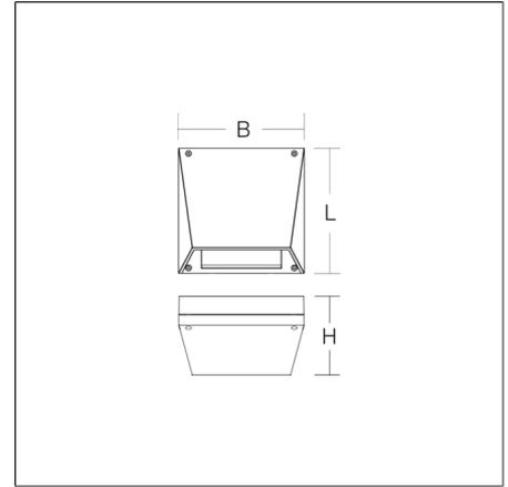
Luminaria de pared para iluminación de emergencia. Carcasa de aluminio inyectado revestido al polvo. Con lentes para iluminación de superficies. Equipo incluido. Sistema de emergencia autónoma con autotest y respuesta a través del bus DALI, exclusivamente al sistema RZB de control DALI.
