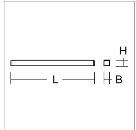
Decken- und Wandleuchte im minimalistischen Design. Gehäuse Aluminium-Strangpressprofil pulverbeschichtet. Endkappen Aluminium pulverbeschichtet. Diffusor aus vergilbungsfreiem Kunststoff (PMMA) opal. Geeignet für Deckenanbau, Wandanbau. Betriebsgerät extern mit Verbindungsleitung.
