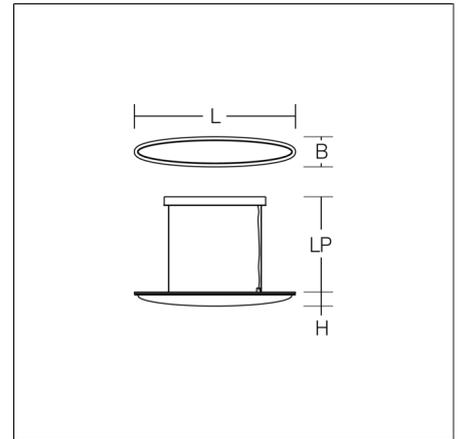
Pendelleuchte in elliptischer Form. Armatur Aluminium pulverbeschichtet. Baldachin und Glashalterung Stahlblech pulverbeschichtet. Handgefertigtes Senkglas, außen mattiert mit weißer Innenlackierung. Homogene und blendfreie Ausleuchtung des Schiffchenkorpus durch speziell angepasste LED-Flächenplatinen. Geeignet für Pendel. 2-Punkt Stahlseilabhängung stufenlos höhenverstellbar oder gewünschte Sonderlängen auf Anfrage.
