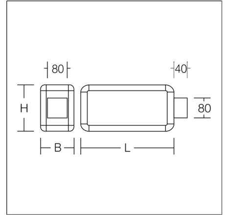
Luminaria con brazo de pared rectangular de diseño clásico. Para señalización de vías de evacuación. Carcasa de aluminio con uniones de esquina de material sintético. Difusores de material sintético opalino con símbolo gráfico de evacuación a una o dos caras. Brazo de pared Equipo incluido. Sistema de emergencia autónoma con autotest y respuesta al sistema RZB de control MULTIDIGIT. Número de artículo del motivo a especificar en el pedido!
