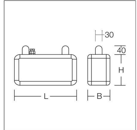
Rechteckige Pendelleuchte im klassischen Design. Zur Rettungswegkennzeichnung. Gehäuse Aluminium mit Eckverbindungen Kunststoff. Kunststoffscheiben opal mit Rettungszeichen einseitig/zweiseitig. Pendelleuchten (Pendel bauseits) für zwei Ketten- oder Seilpendel vorbereitet. Betriebsgeräte integriert. Einzelbatteriesystem mit automatischem Selbsttest. Symbolnummer für Rettungszeichen bei Bestellung angeben!
