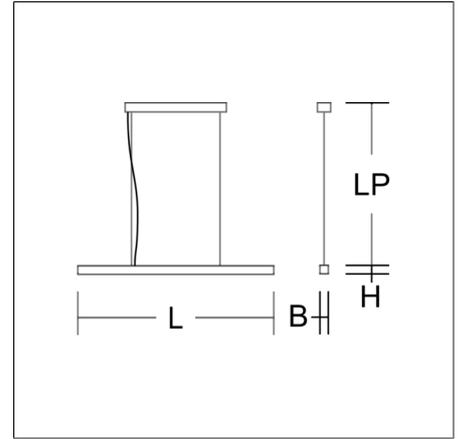
Pendelleuchte in minimalistischem Design. Gehäuse Aluminium-Strangpressprofil pulverbeschichtet. Endkappen Aluminium pulverbeschichtet. Diffusor aus vergilbungsfreiem Kunststoff (PMMA) mikroprismatisch. Lichtaustritt direkt 60%, indirekt 40%. Geeignet für Pendel. 2-Punkt Stahlseilabhangung stufenlos höhenverstellbar oder gewünschte Sonderlängen auf Anfrage. Betriebsgerät im Baldachin integriert.
