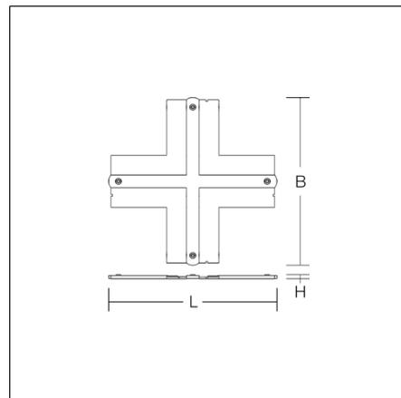
Abdeckung für DALI-Flügelstromschienen, Kunststoff weiß. Geeignet für Winkelkupplungen, Kreuzkupplungen und T-Kupplungen (durch Sollbruchstellen universal verwendbar).
