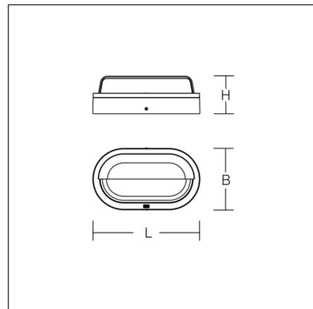
Dekorative Anbauleuchte für den Außenbereich. Gehäuse aus korrosionsbeständigem Aluminium-Druckguss, seewasserbeständig pulverbeschichtet. Mit Membranventil zur Vermeidung von Kondenswasser. Kristallglas innen lackiert, außen mattiert. Schattenfreie, homogene und weiche Ausleuchtung. Mit Netzspannungs-LED-Modul. Wandbefestigung außerhalb des gedichteten Bereiches mit Bohrungstoleranzausgleich. Separater Anschlussraum für Direktanschluss von starren Leitungen bis 3 x 2,5 mm<sup>2</sup>.
