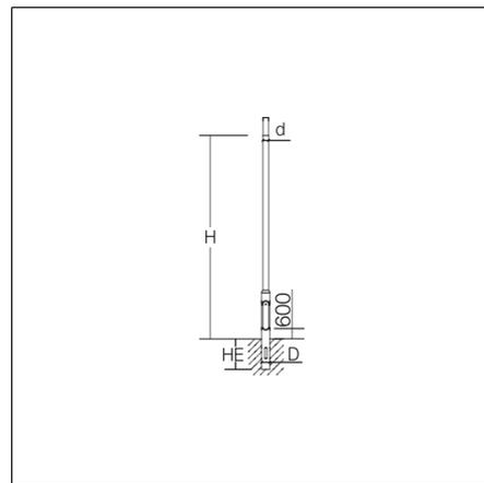
Poste de acero, escalonado cilíndricamente. Galvanizado en caliente conforme a la normativa DIN EN ISO 1461. Grosor de la pared 3 mm. Puerta del poste montada a ras, 85 x 400 mm, conforme a la normativa DIN 48778, con enclavamiento triangular, a petición, con otro modo de cierre. Mallete con dos tuercas correderas y brida para tomatierra. Abertura para cables 50 x 150 mm en la pieza para empotrar en tierra.
