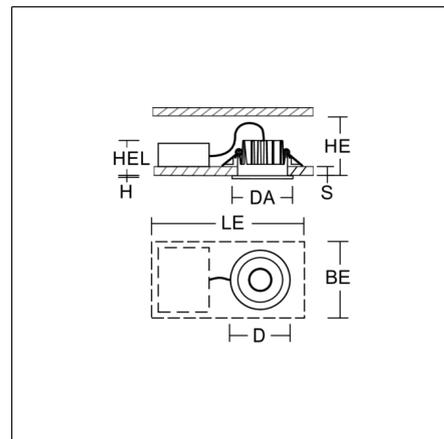
Luminaire de secours rond pour l'éclairage des sorties de secours. Corps en aluminium injecté. Anneau en matière synthétique. Avec optiques à lentilles pour l'éclairage de surface. Système de batterie autonome avec auto-test automatique et retour d'information par bus DALI exclusivement au système de RZB surveillance DALI. Avec l'anneau de fixation au plafond séparé inclus, convient également aux découpes de plafond de Ø 68 mm.
