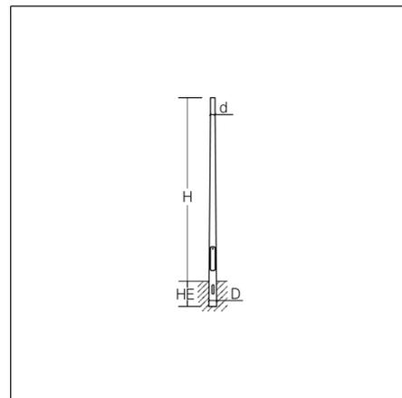
Pylône conique en acier. Galvanisé à chaud selon DIN EN ISO 1461. Trappe du mât affleurante, 85 x 400 mm, selon DIN 48778 avec verrouillage à 3 arêtes, autres fermetures sur demande. Arête de l'appareil avec deux écrous coulissants et une patte de mise à la terre. Orifice de câble 50 x 150 mm (bord inférieur de l'orifice de câble 500 mm sous terre)
