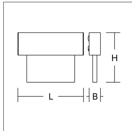
Luminaria para señalización de vías de evacuación. Carcasa de perfil de aluminio extruido, anodizado o revestido al polvo. Difusor display de material sintético transparente con símbolo gráfico de evacuación en una cara. Equipo incluido. Adecuado para conexión a baterías centrales de emergencia. Número de artículo del motivo a especificar en el pedido!
