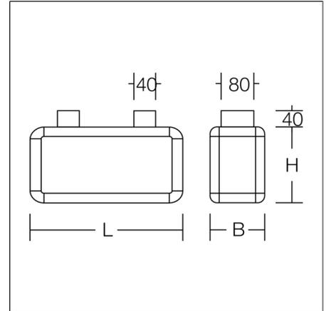
Luminaire apparent rectangulaire au design classique. Pour marquage de voies de secours. Corps en aluminium avec jonctions angulaires en matière synthétique. Plaques en matière synthétique opalines avec pictogramme de secours simple/double face. Appareillage intégré. Système de batterie autonome avec auto-test automatique et retour d'informations au système de surveillance RZB MULTIDIGIT. Merci d'indiquer le numéro de motif du pictogramme de secours lors de la commande
