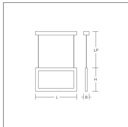
Luminaire pour la signalisation des voies d'évacuation. Corps en aluminium anodisé argent. Plaque display et technique de microlentille brevetée avec pictogramme de secours sur les deux faces. Suspension par câble en 2 points réglable en hauteur en continu. Appareillage intégré. Système de batterie autonome avec auto-test automatique et retour d'informations au système de surveillance RZB MULTIDIGIT. Merci d'indiquer le numéro de motif du pictogramme de secours lors de la commande
