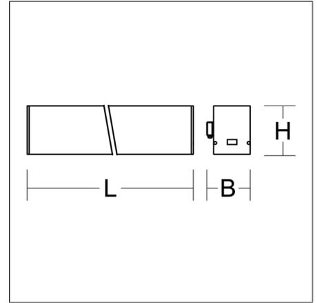
Lineare Wandleuchte. Gehäuse Aluminium-Strangpressprofil pulverbeschichtet. Endkappen Aluminium pulverbeschichtet. Diffusor aus vergilbungsfreiem Kunststoff (PMMA) opal. Lichtaustritt direkt 50%, indirekt 50%. Geeignet für Wandanbau. Austauschbare und herausnehmbare LED-Einheit mit integriertem Betriebsgerät. Für Durchgangsverdrahtung geeignet. Auf Anfrage mit Sensorik oder als Sicherheitsleuchte.
