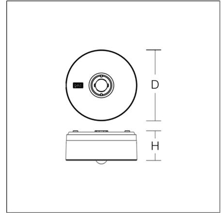
Rundes Anbau-Downlight. Zur Rettungswegbeleuchtung. Gehäuse Kunststoff (Polycarbonat). Abdeckung Kunststoff (Polycarbonat). Kunststofflinsen zur Flächen- und Rettungswegbeleuchtung im Lieferumfang enthalten. Geeignet für Deckenanbau. Einzelbatteriesystem mit automatischem Selbsttest und Rückmeldung über DALI-Bus ausschließlich an das RZB DALI-Überwachungssystem.
