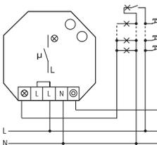
4-Leiter-Schaltung, mit Dachbodenbeleuchtung, nachschaltbar.
