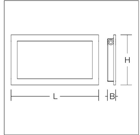
Leuchte zur Rettungswegkennzeichnung. Gehäuse Aluminium silberfarbig eloxiert. Displayscheibe mit patentierter MicroLens-Technik und Rettungszeichen einseitig. Betriebsgeräte integriert. Einzelbatteriesystem mit automatischem Selbsttest und Rückmeldung an das RZB Überwachungssystem MULTIDIGIT. Symbolnummer für Rettungszeichen bei Bestellung angeben!
