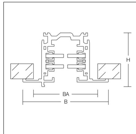
Aluminium-Strangpressprofil lackiert. Schienen beliebig ablängbar. Für den Handbereich zugelassen. Mit integrierter zusätzlicher 2-poliger-DALI-Leitung. Versorgungsleitung 16 A / 400 V. Steuerleitung DALI 2x 1 A / 50 V FELV AC.
