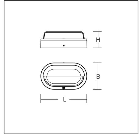
Dekorative Anbauleuchte für den Außenbereich. Gehäuse aus korrosionsbeständigem Aluminium-Druckguss, seewasserbeständig pulverbeschichtet. Mit Membranventil zur Vermeidung von Kondenswasser. Kristallglas innen lackiert, außen mattiert. Schattenfreie, homogene und weiche Ausleuchtung. Mit Netzspannungs-LED-Modul. Wandbefestigung außerhalb des gedichteten Bereiches mit Bohrungstoleranzausgleich. Separater Anschlussraum für Direktanschluss von starren Leitungen bis 3 x 2,5 mm<sup>2</sup>.
