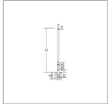
Poste de acero, escalonado cilíndricamente. Galvanizado en caliente conforme a la normativa DIN EN ISO 1461. Grosor de la pared 3 mm. Puerta del poste montada a ras, 85 x 400 mm, conforme a la normativa DIN 48778, con enclavamiento triangular, a petición, con otro modo de cierre. Mallete con dos tuercas correderas y brida para tomatierra. Abertura para cables 50 x 150 mm en la pieza para empotrar en tierra.
