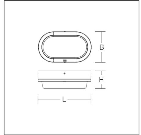
Dekorative Anbauleuchte für den Außenbereich. Gehäuse aus korrosionsbeständigem Aluminium-Druckguss, seewasserbeständig pulverbeschichtet. Mit Membranventil zur Vermeidung von Kondenswasser. Kristallglas innen lackiert, außen mattiert. Schattenfreie, homogene und weiche Ausleuchtung. Befestigung außerhalb des gedichteten Bereiches mit Bohrungstoleranzausgleich. Separater Anschlussraum für Direktanschluss von starren Leitungen bis 3 x 2,5 mm<sup>2</sup>. Tauschbares LED-Modul.
