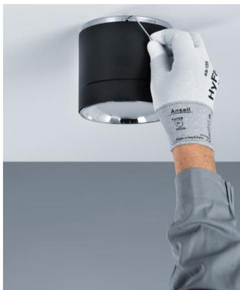
Die Leuchte wird mit einem Bajonettverschluss an der Montageplatte befestigt. Eine innenliegende Madenschraube dient als zusätzliche Fallsicherung.
