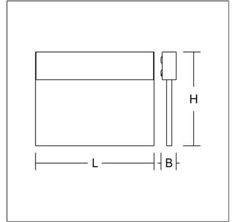
Luminaire pour la signalisation des voies d'évacuation. Corps en profilé d'aluminium extrudé, anodisé ou traité époxy. Plaque display en matière synthétique haute transparence avec pictogramme de secours simple face. Appareillage intégré. Système de batterie autonome avec auto-test automatique et retour d'information par bus DALI exclusivement au système de RZB surveillance DALI. Merci d'indiquer le numéro de motif du pictogramme de secours lors de la commande
