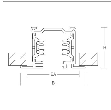
Extrudé aluminium profilé laqué, rails pouvant être raccourcis à volonté, manipulation sans risques, avec cinq alésages de fixation à 100, 990, 1990, 2990, 3875 mm.
