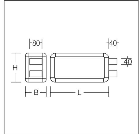
Rechteckige Wandauslegerleuchte im klassischen Design. Zur Rettungswegkennzeichnung. Gehäuse Aluminium mit Eckverbindungen Kunststoff. Kunststoffscheiben opal mit Rettungszeichen einseitig/zweiseitig. Wandbefestigungsbügel für stirnseitige Montage Betriebsgeräte integriert. Einzelbatteriesystem mit automatischem Selbsttest. Symbolnummer für Rettungszeichen bei Bestellung angeben!
