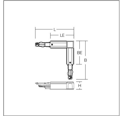
Winkelkupplung 90°, Kunststoff. Mit integrierter zusätzlicher 2-poliger-DALI-Leitung. Versorgungsleitung 16 A / 400 V. Steuerleitung DALI 2x 1 A / 50 V FELV AC.
