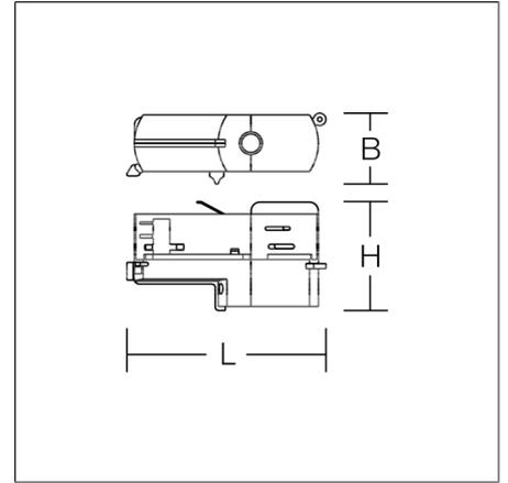
Adaptador universal para carriles de corriente trifásica, apto para carriles DALI de RZB. Conexión a un conductor de puesta a tierra. Conmutador selector de fases. Toma para línea bus de 2 polos.
