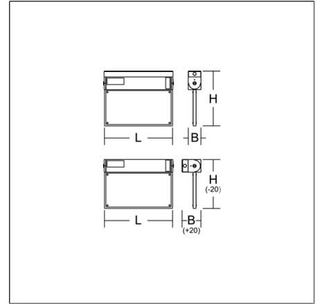
Luminaria para señalización de vías de evacuación. Carcasa de perfil de aluminio extruido, revestido al polvo. Se adjuntan láminas enchufables: 4 con símbolo gráfico de evacuación y una lámina blanca, incluidos clips de sujeción. Juego de sujeción universal para montaje en superficie de techo y pared. Equipo incluido. Sistema de emergencia autónoma con autotest. Con interfaz de programación NFC.
