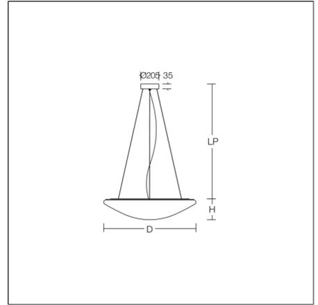
Dekorative runde LED Pendelleuchte. Armatur und Baldachin Metall pulverbeschichtet weiß. Baldachin Ø 205 mm, h 35 mm. Diffusor aus vergilbungsfreiem Kunststoff (PMMA) opal. Befestigung des Diffusors mit patentierter Verschluss-technik (Druckverschluss). Geeignet für Pendel. 3-Punkt Stahlseilabhangung stufenlos höhenverstellbar oder gewünschte Sonderlängen auf Anfrage.
