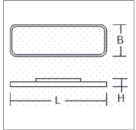
Panel luminoso decorativo de LED de montaje en superficie, rectangular. Marco plano de perfil de aluminio extruido revestido al polvo. Base de metal revestido al polvo. Difusor de material sintético opalino (PMMA) que no amarillea. Tecnología LED backlight proporciona luz homogénea en todo el difusor. Apto para Montaje en superficie de techos, Montaje en superficie de la pared. Instalación sencilla mediante sistema Plug & Play. Equipo incluido. DALI regulable. Apto para cableado de paso.
