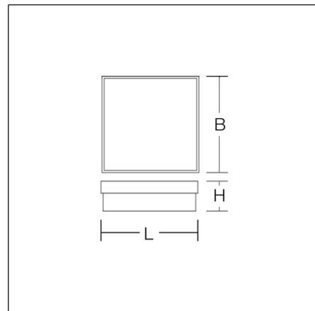
Luminaire apparent plat carré. Armature en matière synthétique. Diffuseur en matière synthétique (polypropylène) opalin mat satiné. Fixation du diffuseur par système de ressorts. IP 43 montage au plafond, IP 44 montage mural.
