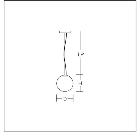
Pendelleuchte in zeitlos klassischem Kugeldesign. Baldachin Metall pulverbeschichtet, weiß. Kappe Metall pulverbeschichtet weiß. Diffusor mundgeblasenes Opalglas seidenmatt. Schattenfreie, homogene und weiche Ausleuchtung. 1-Punkt Stahlseilabhängung stufenlos höhenverstellbar oder gewünschte Sonderlängen auf Anfrage. Zuleitung weiß.
