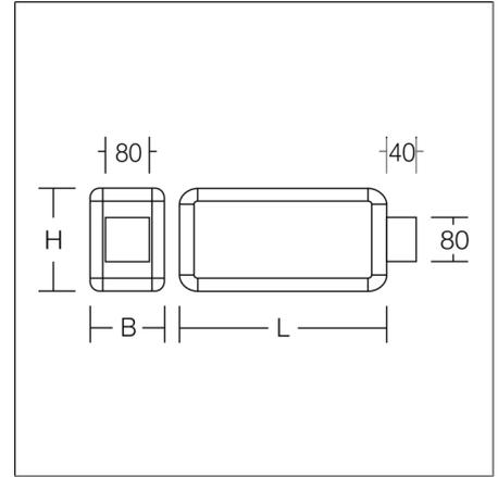
Rechteckige Wandauslegerleuchte im klassischen Design. Zur Rettungswegkennzeichnung. Gehäuse Aluminium mit Eckverbindungen Kunststoff. Kunststoffscheiben opal mit Rettungszeichen einseitig/zweiseitig. Wandbefestigungsbügel für stirnseitige Montage Betriebsgerät integriert. Zum Anschluss an zentrale Sicherheitsstromversorgung geeignet. Mit Überwachungsbaustein AC-Control für LUXIFAIR Zentralbatterie-Anlagen. Symbolnummer für Rettungszeichen bei Bestellung angeben!
