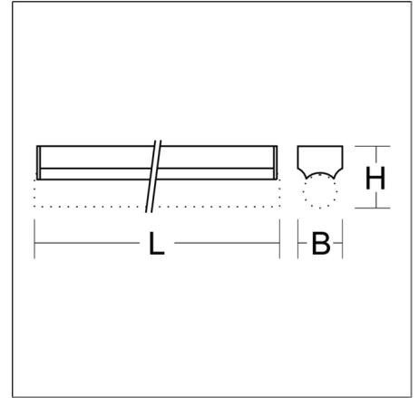
Aplique de aluminio para lámparas lineales. Base de aluminio extruido, anodizado. Tapas laterales de material sintético. Al quitar la lámpara las monturas se conmutan automáticamente sin tensión. Pedir lámpara por separado.
